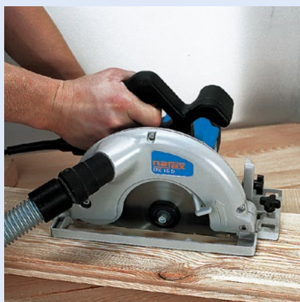
Připojení kotoučové pily k vysavači pro dokonale čistou práci
